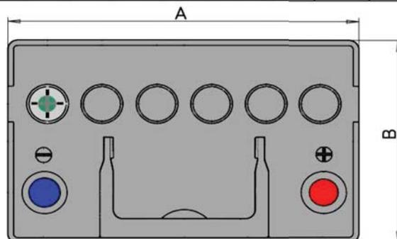
**BATTERIA** senza manutenzione, costruita con lega Pb/Sb a basso contenuto di antimonio secondo Norma DIN
